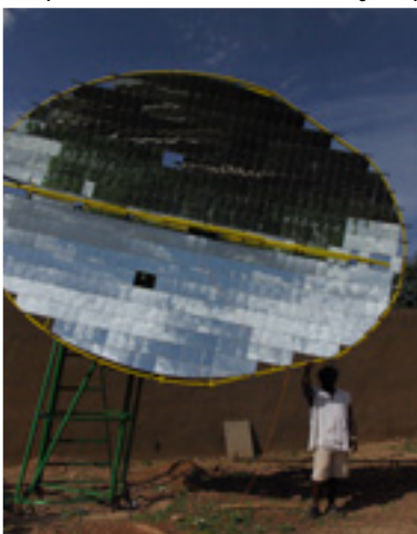
Parabole solaire en matériaux locaux dans un atelier de Ouagadougou
